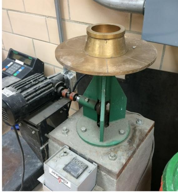
**Figure 27. Photo. Flow table apparatus.**
