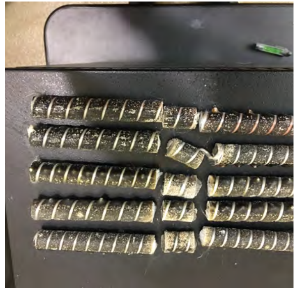
(d) No Rust #5
