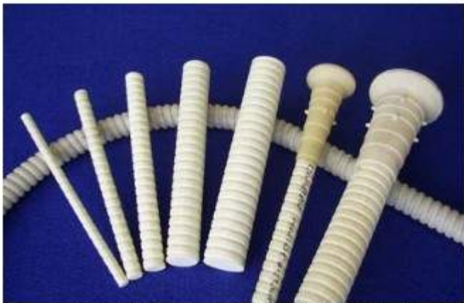
Figure 2-6: FRP rebar (Schöck Bauteile GmbH)
