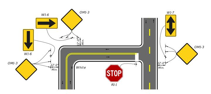
Figure 1 TRAFFIC CONTROLS FOR MINOR STREET TERMINATION
