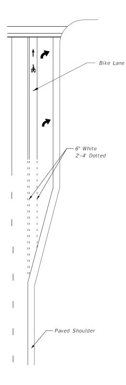
FLUSH SHOULDER ROADWAY INTERSECTION WITH SEPARATE RIGHT-TURN LANE
