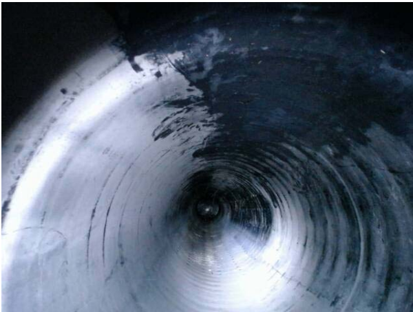
(d) French drain RCA with 4% fines
