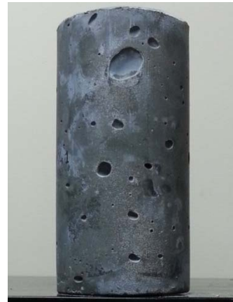
(d) F30 Large air voids
