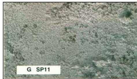
(d) Condition G cleaned to SP11 using power tools
