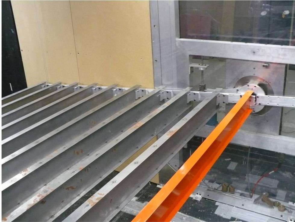
**a) TEST W9, INSTRUMENTED GIRDER LEEWARD (10<sup>TH</sup> POSITION)**
