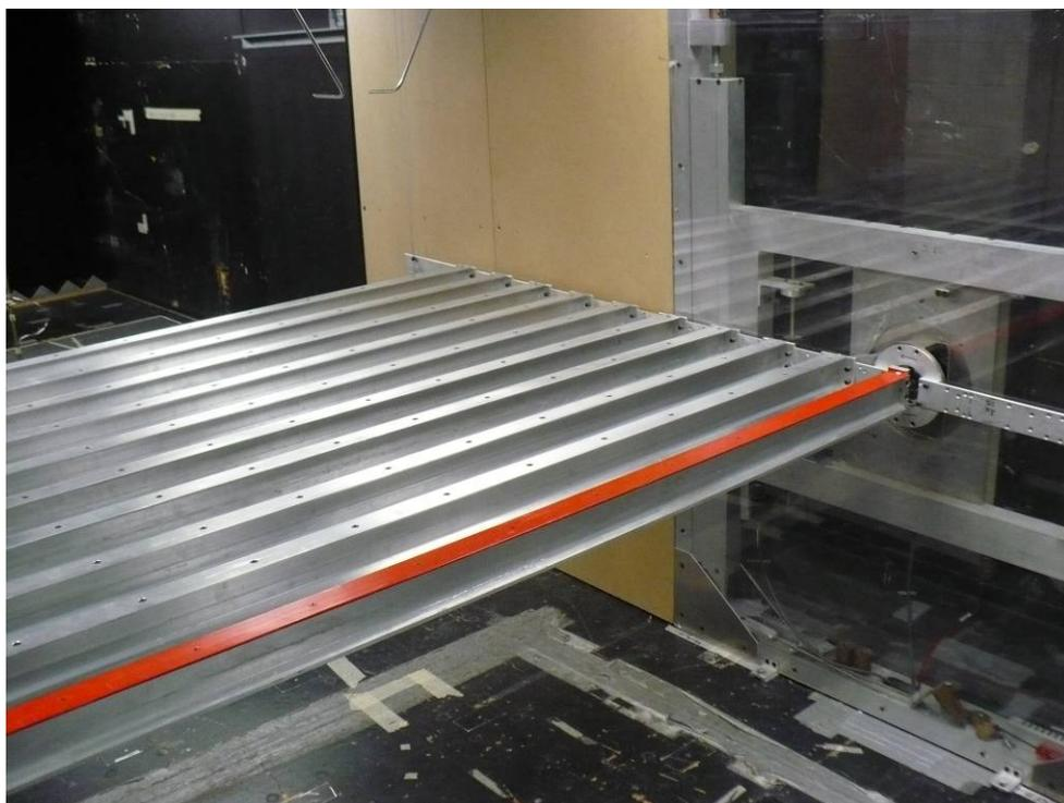
**a) TEST T9, INSTRUMENTED I-BEAM LEEWARD (10<sup>TH</sup> POSITION)**
