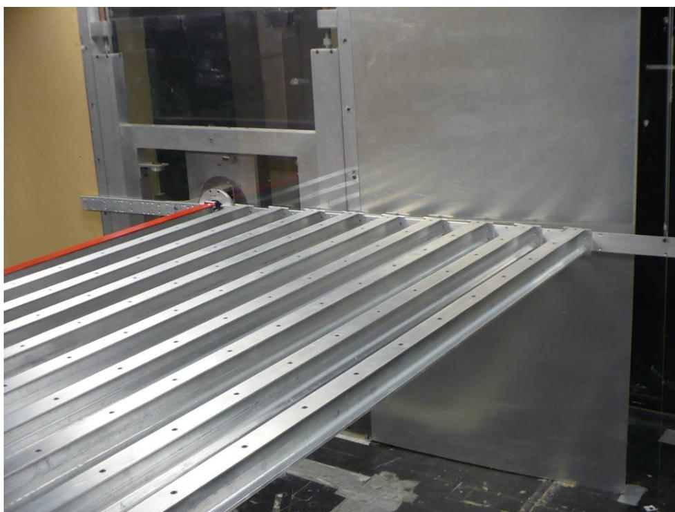
**b) TEST D0, INSTRUMENTED I-BEAM WINDWARD (1<sup>ST</sup> POSITION)**
