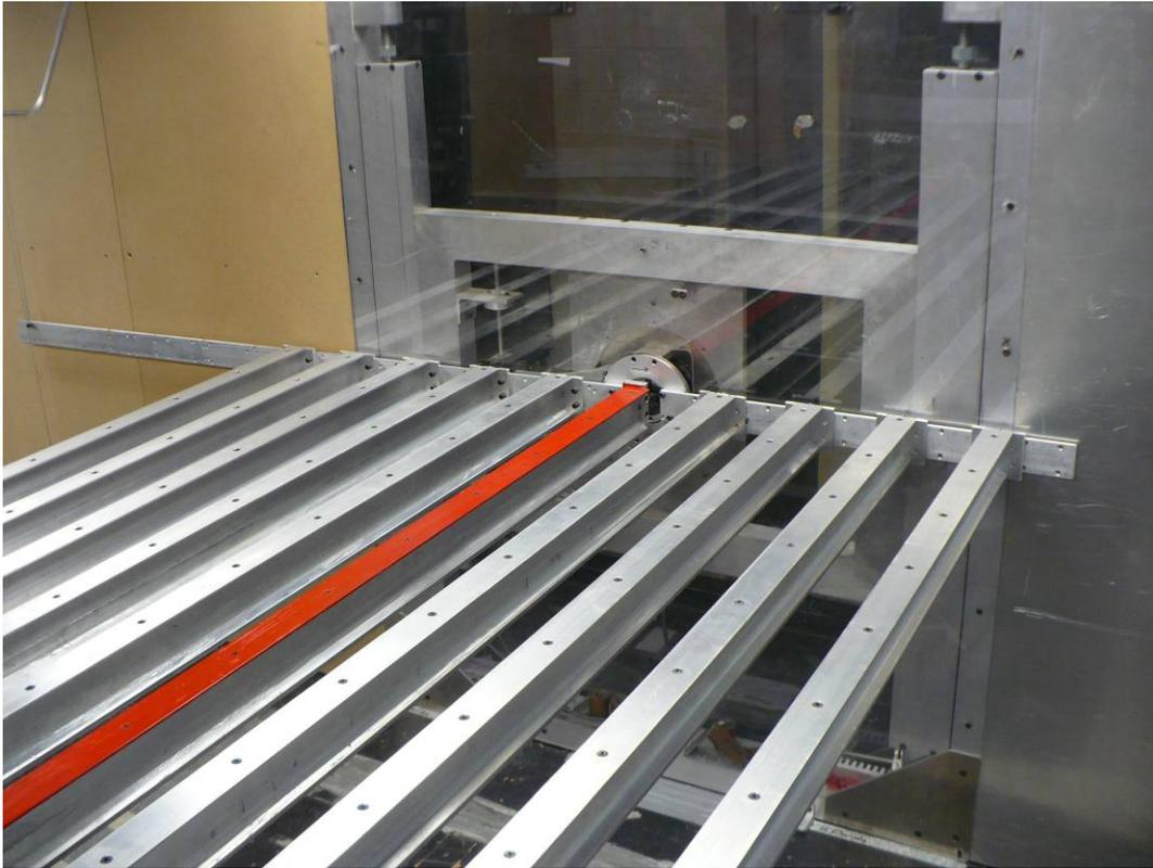
**c) TEST D5, INSTRUMENTED GIRDER AT 6<sup>TH</sup> POSITION**
